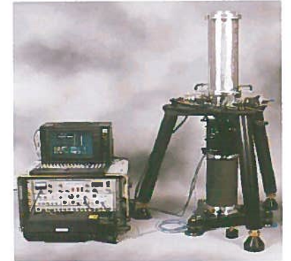
Mutlak Gravite Ölçer Absolute Gravity Instrument
