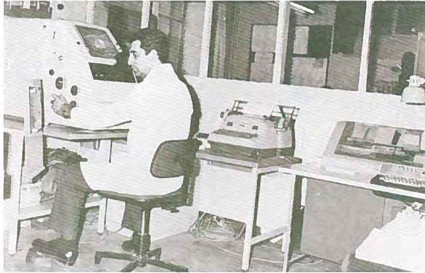
Zeiss Firmasına Ait Stereokomparator Aleti ile Fotogrametrik Nirengi Çalışması Yapılırken During the Photogrammetric Triangulation Research with Stereocomparator Instrument Belonging to the Zeiss Firm
