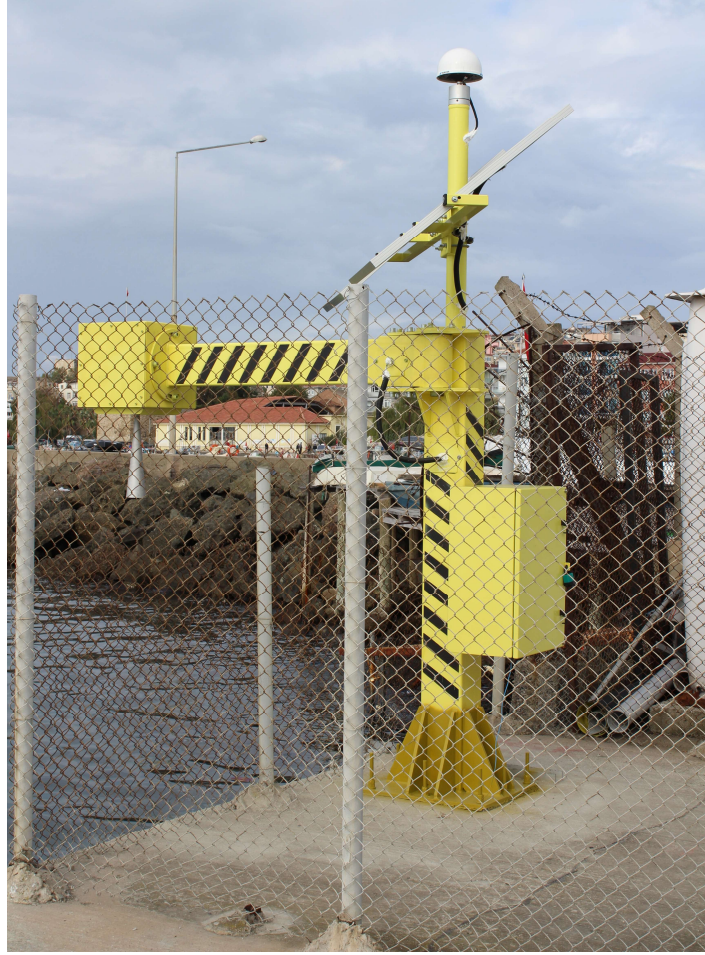
Şekil 5: Sabit GNSS alıcısı entegreli radar deniz seviyesi ölçer istasyon
