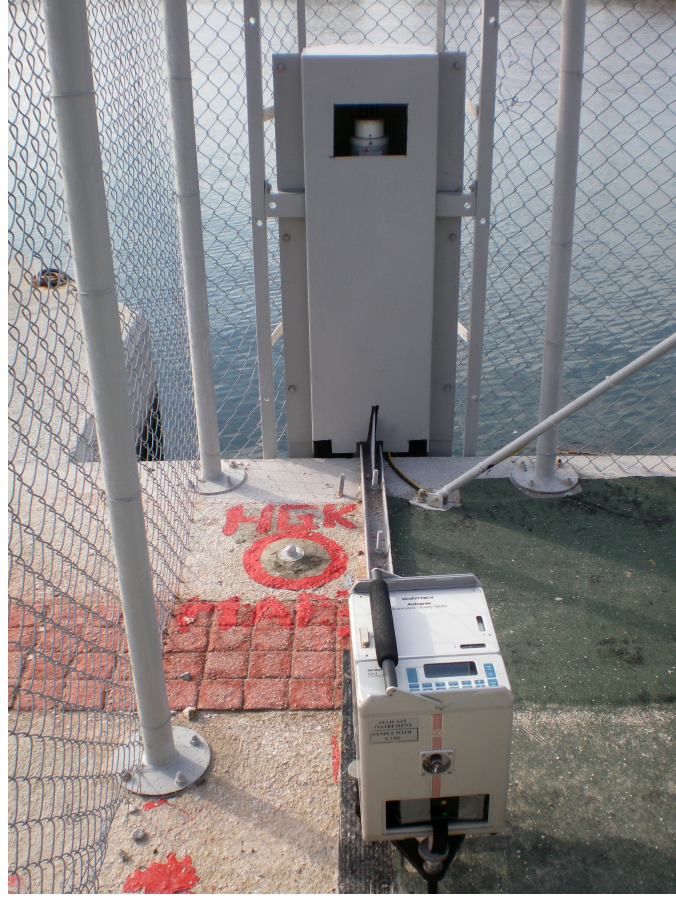
Şekil 4: Mareograf istasyonlarında yapılan gravite ölçümleri.
