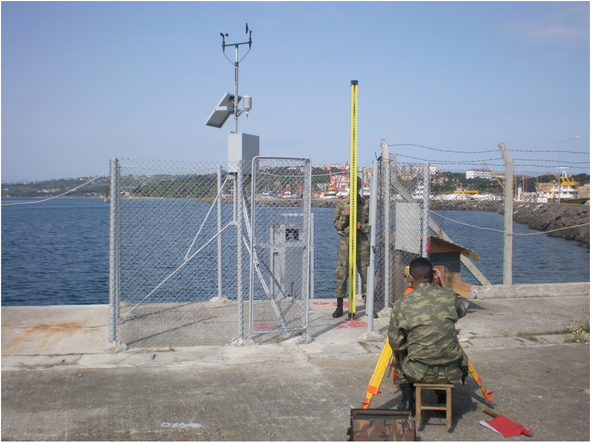
Şekil 3: Mareograf istasyonlarında yapılan nivelman ölçümleri.
