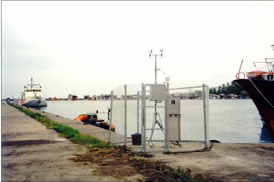
řekil-8: Trabzon-II sayısal ve otomatik mareograf istasyonundaki deniz seviyesi lme aleti.
