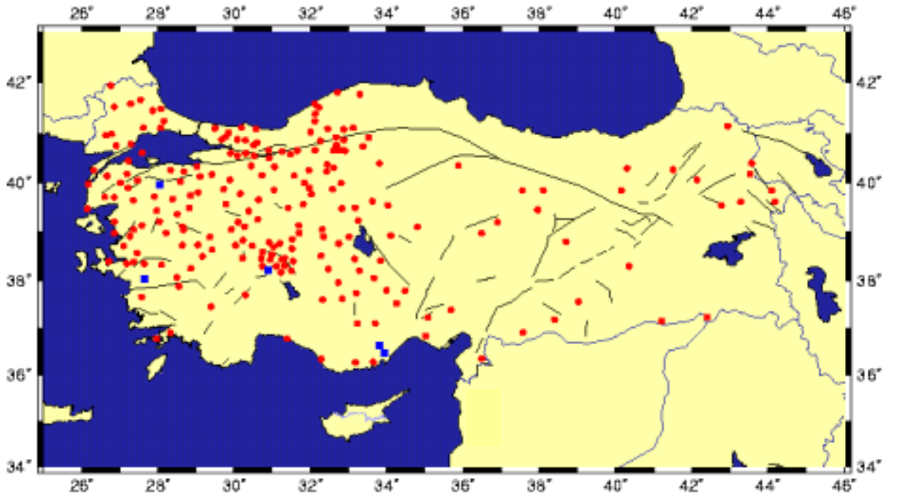
Şekil-4.1: TUTGA-99A ve ED-50 koordinatları bilinen ortak noktalar. Kırmızı daireler dönüşümde kullanılan ortak noktalar, mavi kareler enlem dönüşümünde uyumsuz bulunup kullanılmayan noktalardır.
