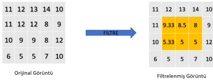
Şekil 13. Filtrenin uygulama adımları (IV)
