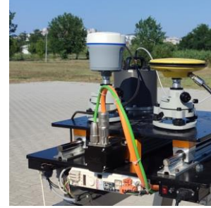
Şekil 1. Çalışmada kullanılan sarsma tablası ve GNSS alıcıları
