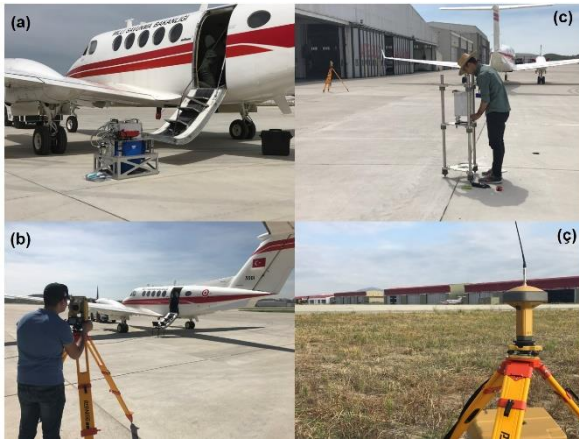
Şekil 7. (a) Hava gravimetrisinin uçak içerisine yerleştirilmesi, (b) SIMU-GNSS anteni arası baz vektörü ölçümü, (c) Gravite bağlantı noktası ölçümü, (ç) GNSS referans istasyonu.
