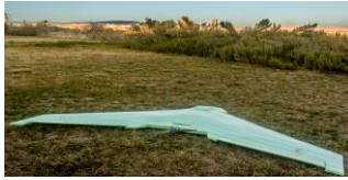
Şekil 3. Çalışma alanında veri toplamak için kullanılan sabit kanatlı İHA ve monte edilmiş dijital kamera
