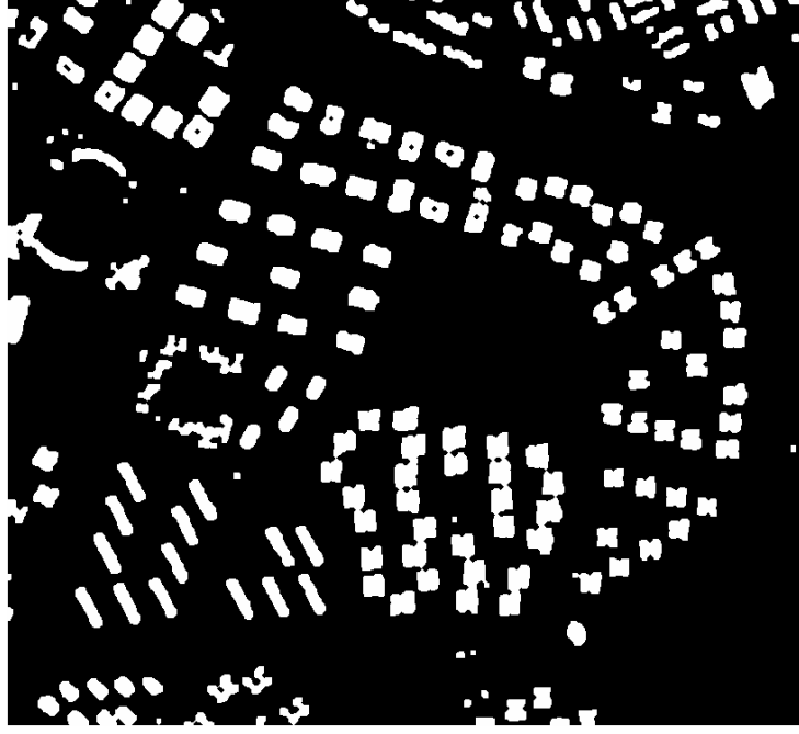
Şekil 9. Üretilen çıktının morfolojik görüntü işleme operatörleriyle iyileştirilmesi sonucu elde edilmiş olan iyileştirilmiş çıktı.
