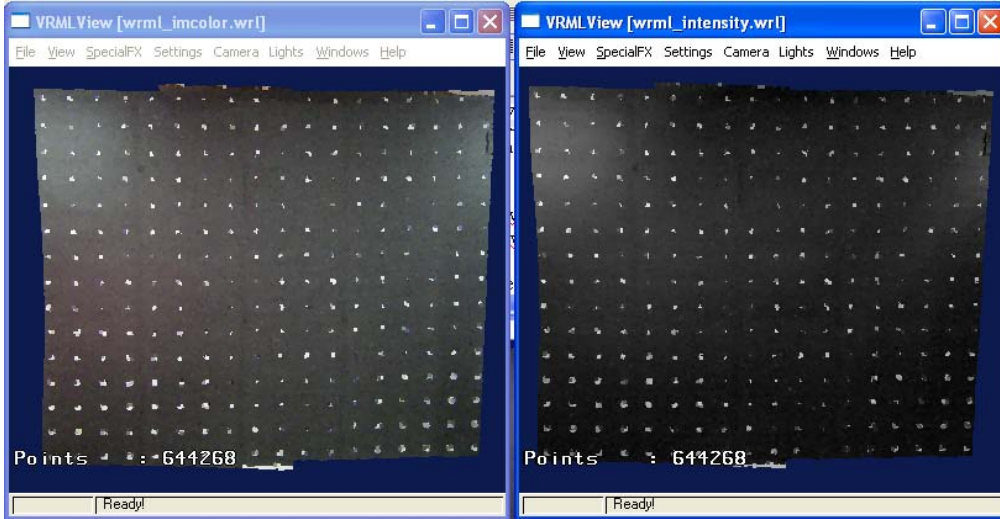
Şekil 6. Lazer tarama verisinin kamera renkleri (solda) ve yansımaya değerleri ile görüntüleri (sağda).
