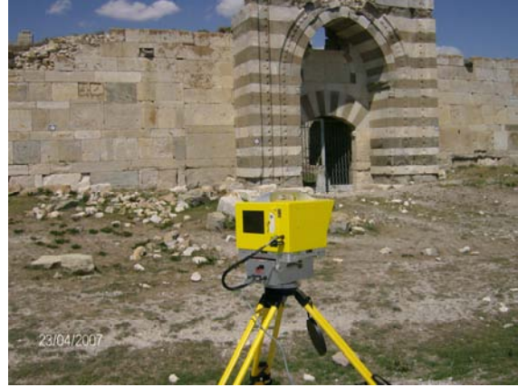
Şekil 3. Zazadin Han lazer taraması ve obje üzerinde işaretlenmiş noktalar.
