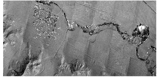
Şekil 3: SYM'lerin farklarından (LiDAR-LPS) elde edilen yükseklik fark görüntüsü
