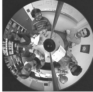
Şekil 7. Parabolik ayna ile elde edilen çok yönlü görüntü
