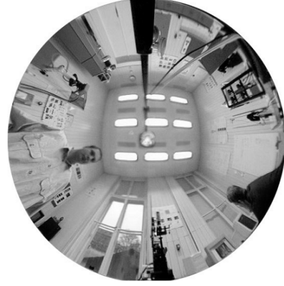
Şekil 5. Hiperbolik ayna ile elde edilen çok yönlü görüntü
