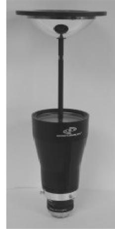
Şekil 1. Ayna mercek kombinasyonlu bir algılayıcı sistemi (Bastanlar, 2005)
