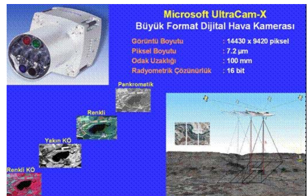
Şekil 3. Microsoft UltraCam-X sayısal hava kamerası özellikleri.
