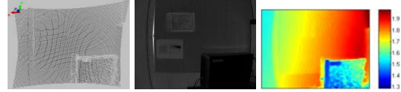
Şekil 4. SR4000 kamera ölçüsü. Nokta bulutu (solda), yansıma (ortada) ve mesafe (sağda) görüntüleri (birimler metredir)
