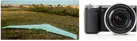
Şekil 3. Çalışma alanında veri toplamak için kullanılan sabit kanatlı İHA ve monte edilmiş dijital kamera
