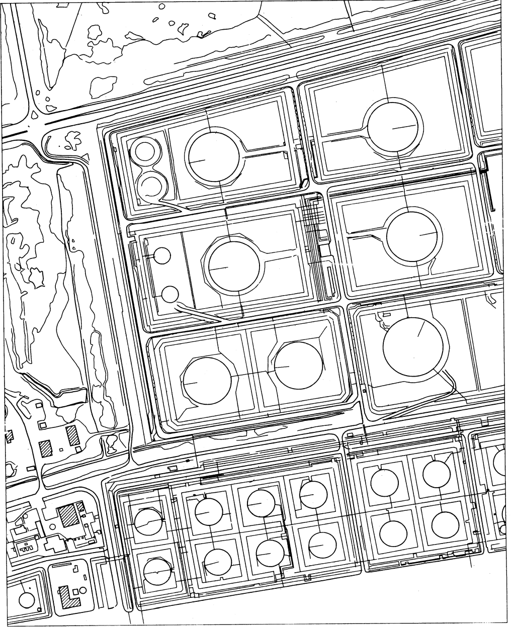
Şekil III. Sayısal Fotogrametrik kıymetlendirme ve otomatik çizim (havre bağımsız limanı) ÖLÇEK 1/5000 yapım. I. G.N.
