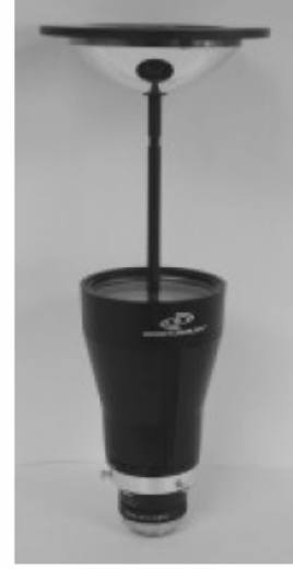
Şekil 6. Ayna-mercekten oluşan katadioptrik algılayıcı örneği.
