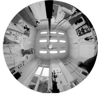
Şekil 7. Hiperbolik ayna ile elde edilen küresel görüntü.
