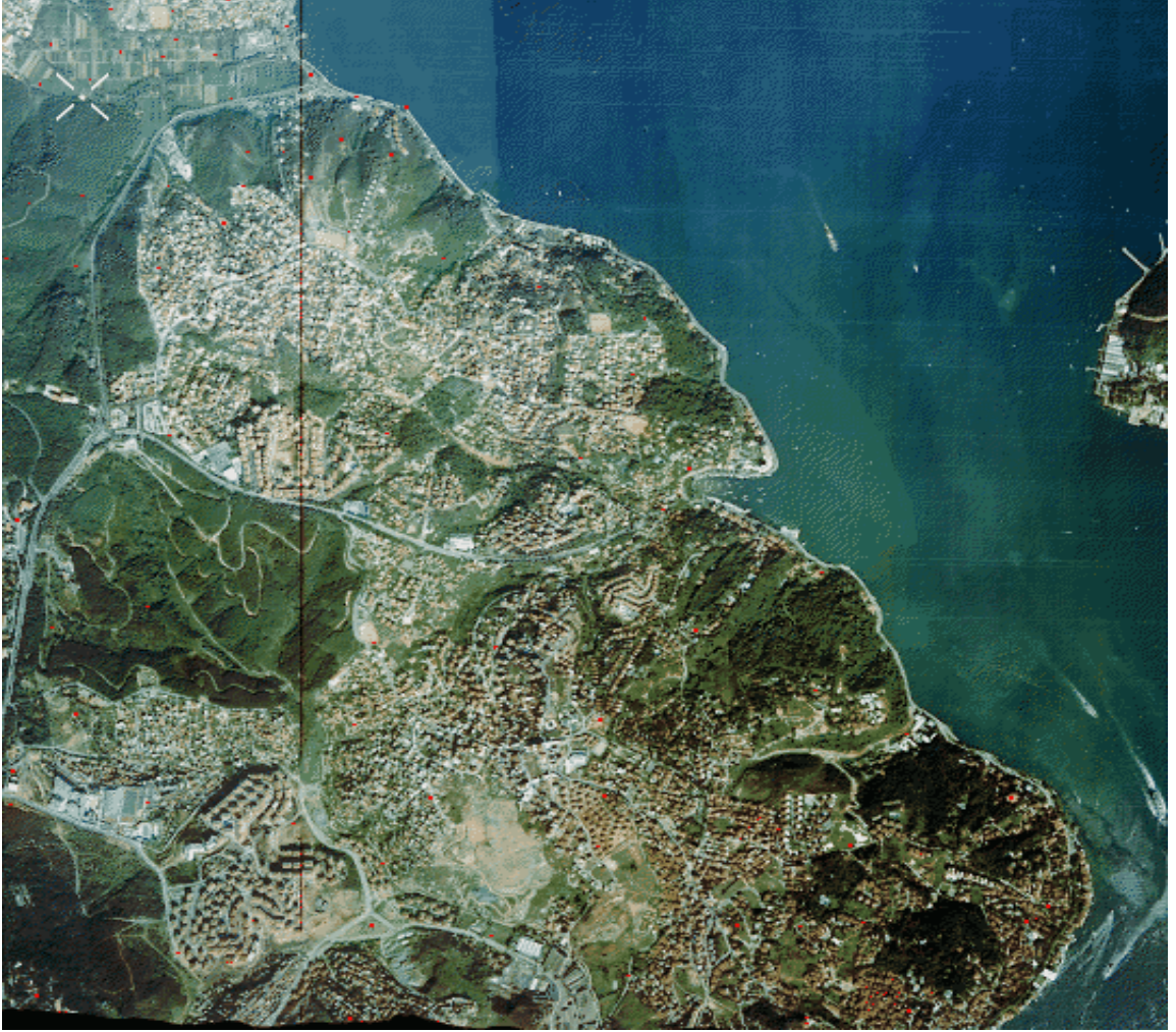
Resim-7 : 1/5.000 Ölçekli Eş Yükseklik Eğrilerinden Üretilen Ortofoto Görüntüsü
