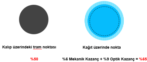
Şekil 18. Nokta kazancı (dot gain) tram noktasının yapısında meydana Gelen değişim
