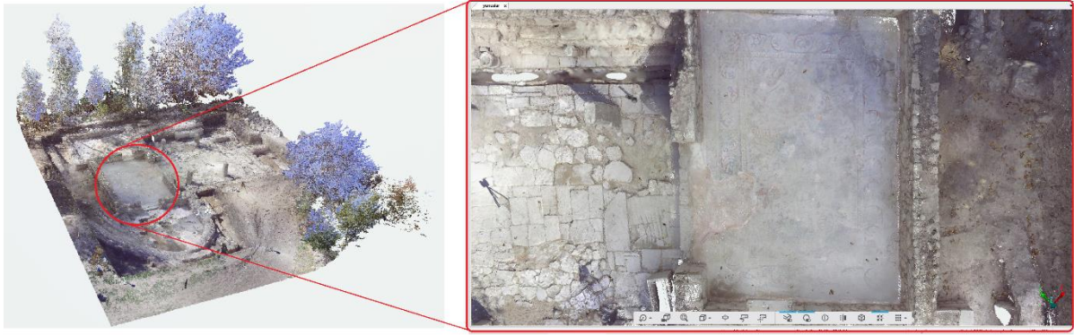
Şekil 18. Yersel lazer tarama sonucun oluşan 3B model.
