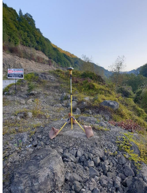
Altıncı iş paketi kapsamında GNSS/Nivelman çalışmaları.
