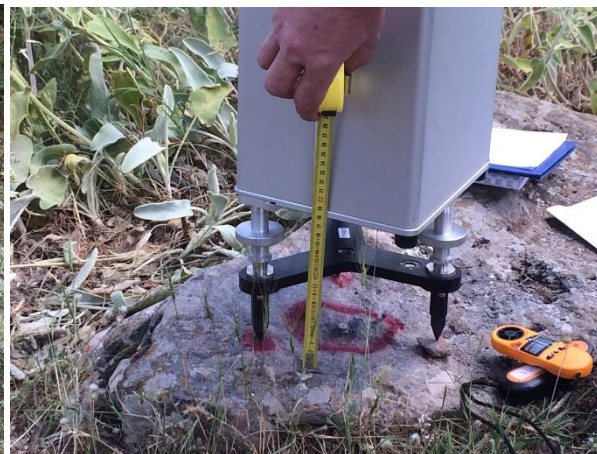
Üçüncü iş paketi kapsamında bağıl gravimetri çalışmaları.
