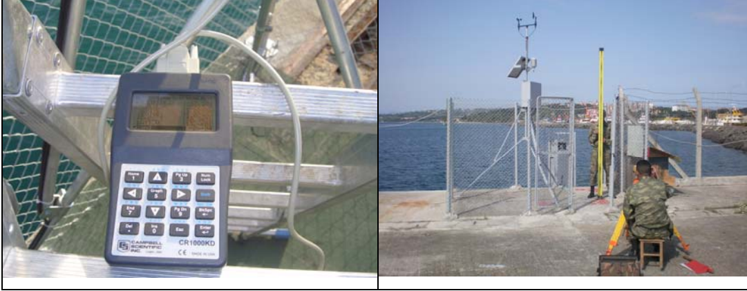
Şekil 2-14 : Sensörlerin fonksiyon testlerinin yapılması ve yükseklik farklarının belirlenmesi.
