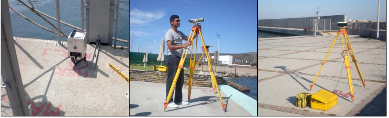
Şekil 2-19: Mareograf istasyonlarında gravite, nivelman ve GPS ölçümleri.
