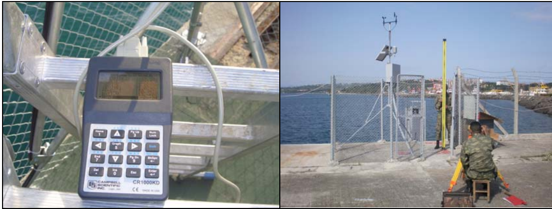
Şekil 2-16: Sensörlerin fonksiyon testlerinin yapılması ve yükseklik farklarının belirlenmesi.
