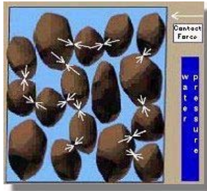
Şekil 2. Zemin tanelikleri; okların uzunluğu zemin parçaları arasındaki bağlantı gücünü göstermektedir. Su basıncı azaldıkça bağlantı gücü artmaktadır.
